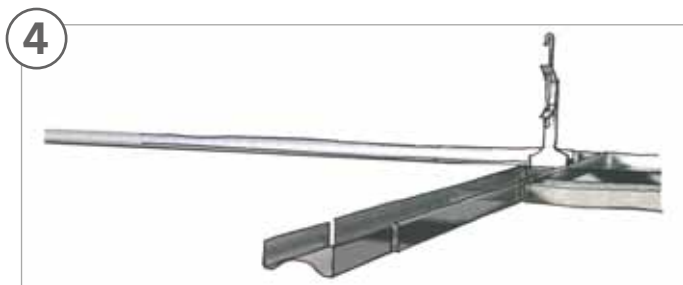
4. Bärprofilens ände skjuts in i kansen och skarvas med skarvbeslag GK20.
